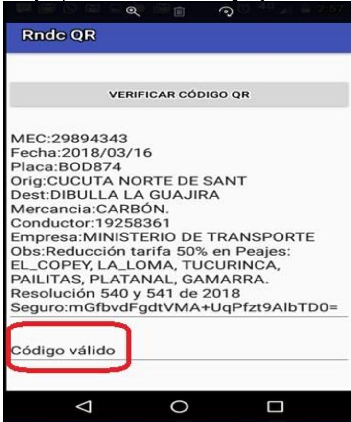
Se observa que cada Dato se muestra desde la columna 1. Eso es porque al armar la cadena de texto que se convierte a QR, se deben adicionar dos caracteres después de cada dato: "Carriage Return" y "Line Feed" (en decimal: CR=13, LF=10), si esos caracteres no se adicionan después de cada dato, los lectores de los códigos QR mostrarían una cadena de caracteres continua, muy difícil de analizar.
